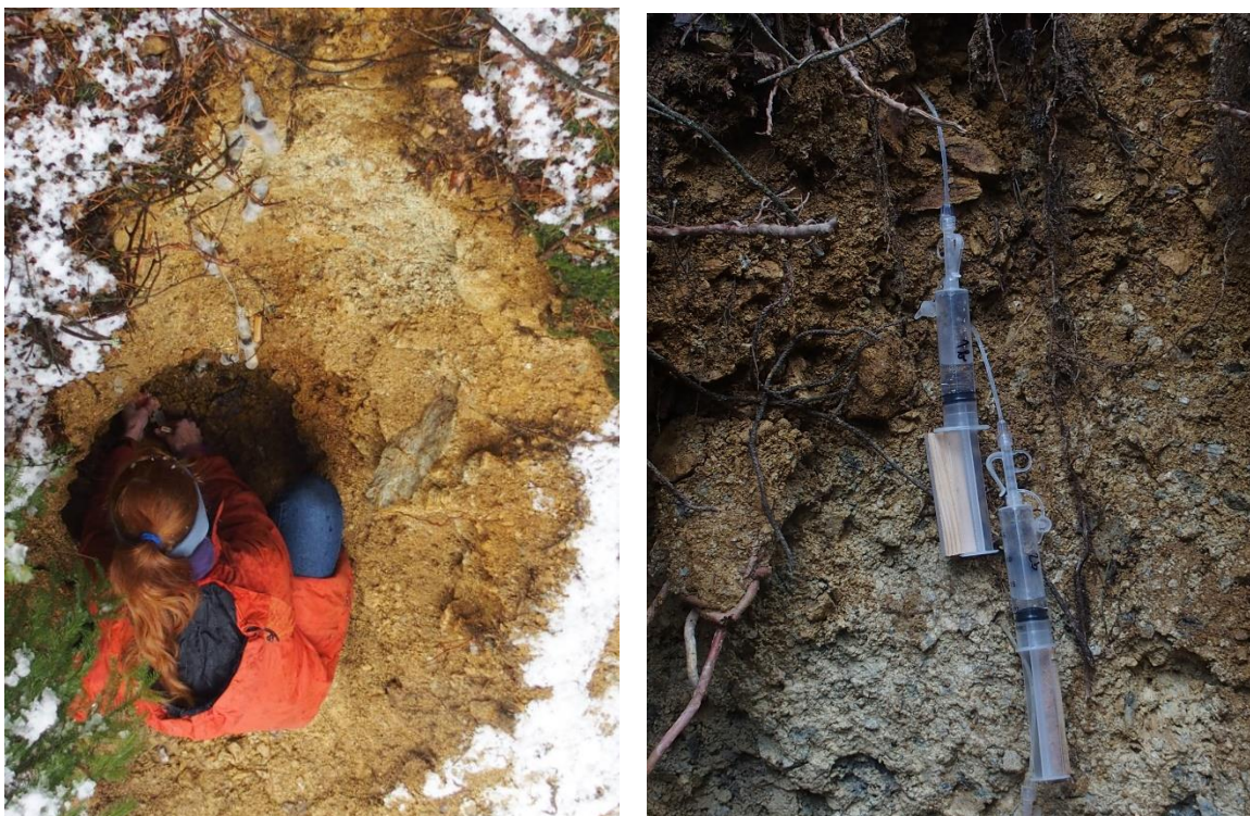
Obr. 5: Odběr pórové vody pomocí lyzimetrů značky Rhizon na lokalitě Dlouhá Ves.
