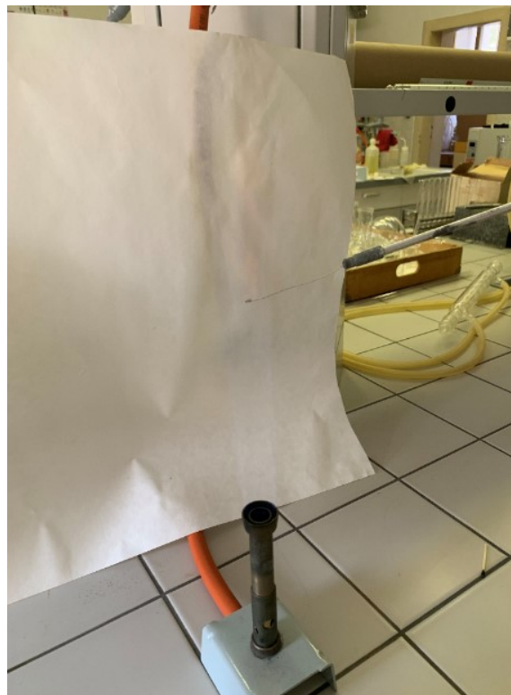
Obrázek 11 – Plamenová zkouška (sacharóza)
