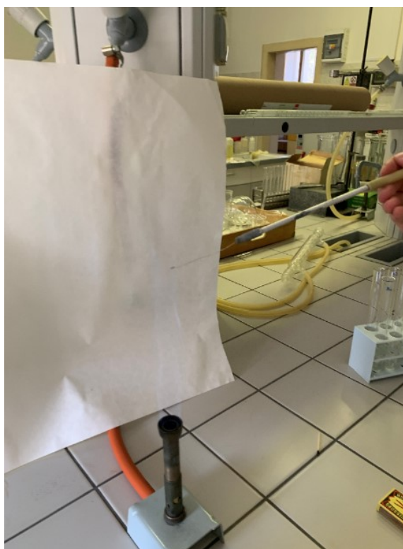
Obrázek 10 – Plamenová zkouška (oxid hlinitý)
