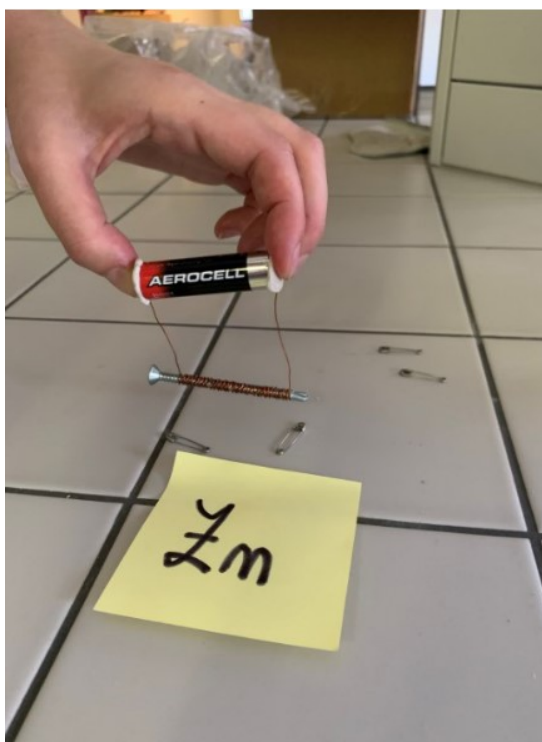
Obrázek 13 – Zinkový hřebík s měděnou cívkou nepřitahující kovové sponky
