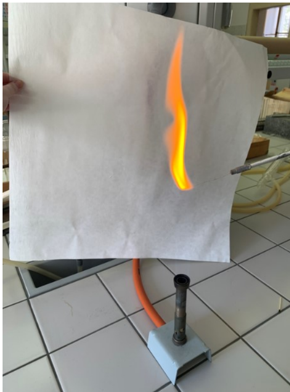
Obrázek 7 – Plamenová zkouška (sodík obsažený v NaCl)
