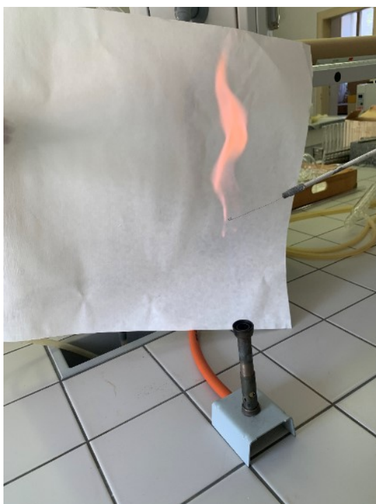
Obrázek 8 – Plamenová zkouška (draslík obsažený v KCl)
