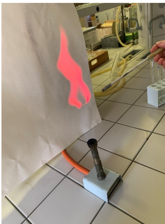
Obrázek 9 – Plamenová zkouška (lithium obsažené v LiCl)
