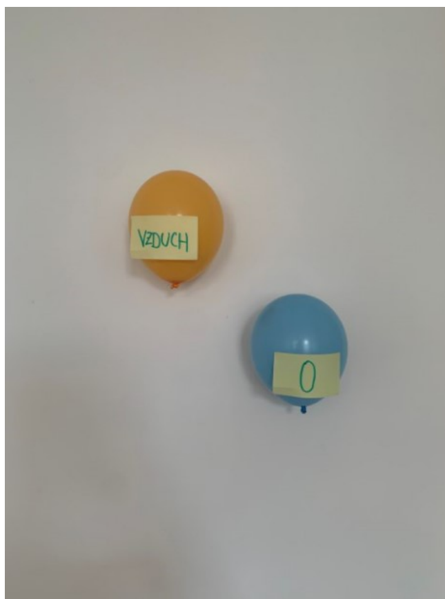
Obrázek 6 – Balonky naplněny vzduchem a kyslíkem, kdy po vypuštění balonků ve stejnou dobu, balonek s kyslíkem klesá v místnosti u stěny k zemi rychleji než balonek se vzduchem
