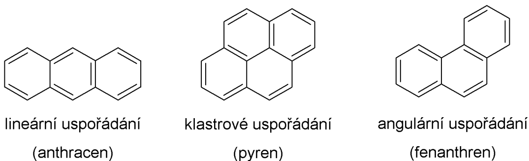
Obr. 2.1 Různé typy uspořádání benzenových jader v molekule PAU
