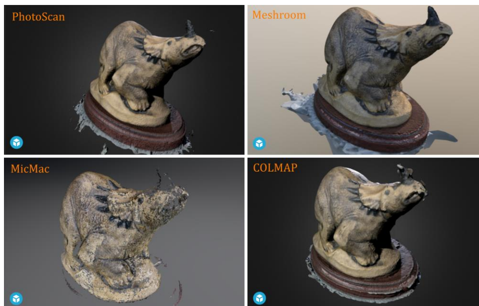
Obrázek 5: Srovnání 3D modelů vytvořených v různých SFM programech
