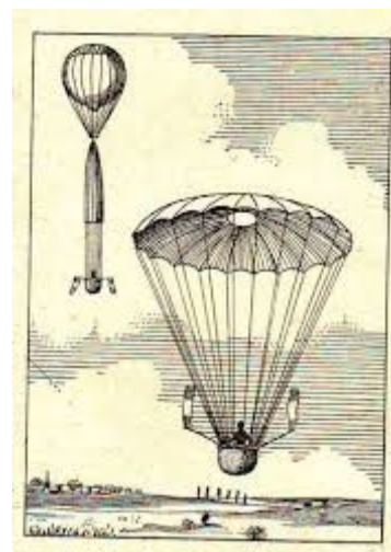
Obr. č. 3, Garnerinův padák zdokonalený kruhovým otvorem ve vrchlíku
