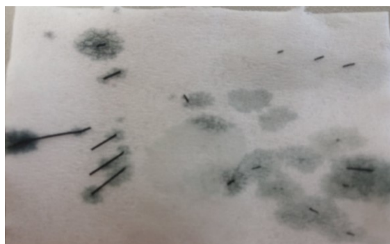
Obr. 20 Tvar polyanilínu vyplňujúceho vnútro kapiláry s priemerom 0,32 mm
