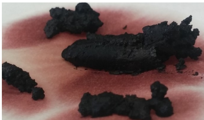
Obr. 14 Polyanilín pripravený oxidáciou roztoku tris(4-aminofenyl)amínu v anilíne s ekvimolárnym množstvom peroxodisíranu amónneho
