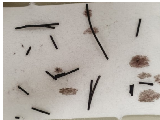
Obr. 19 Tvar polyanilínu vytlačeného z kapiláry A3
