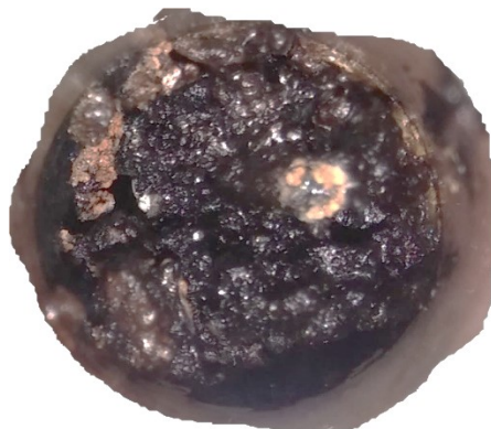
Obr. 13 Štruktúra polyanilínu pripraveného použitím peroxodisíranu amónneho v molárnom pomere 1/1
