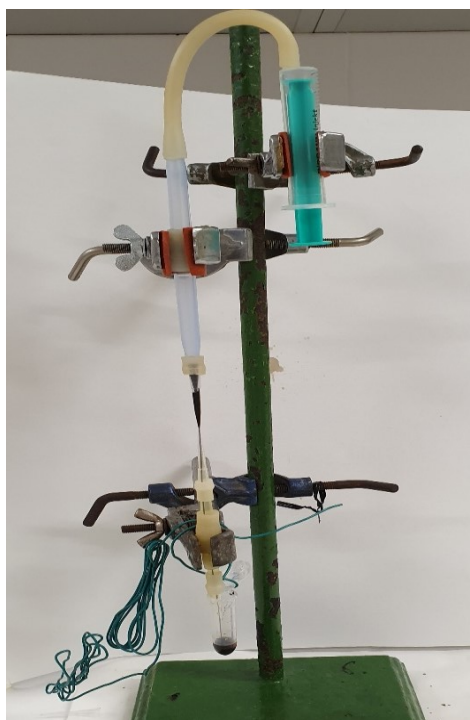
Obr. 9 Aparatúra B s chladiacou časťou na kapiláre
