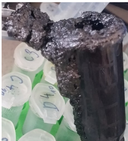
Obr. 12 Penovitá konzistencia polyanilínu pripraveného polymerizáciou s 1,9násobným nadbytkom peroxidu vodíka
