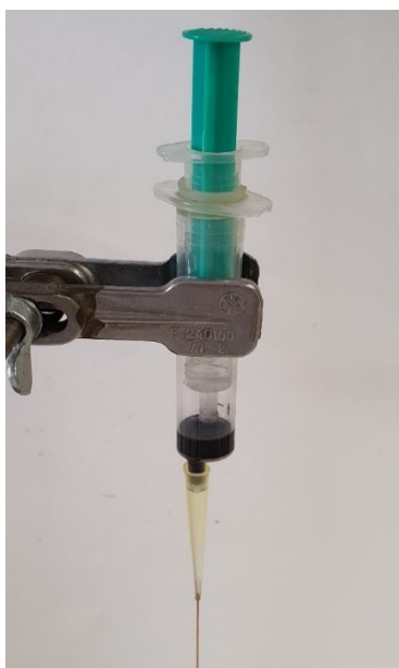
Obr. 10 Zjednodušená aparátúra C na plnenie kapilár
