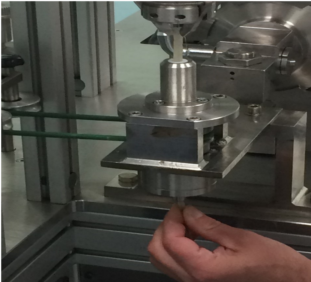
Obr. 11: Extruze rybího kolagenu z matrice na silikonovou trubici.
