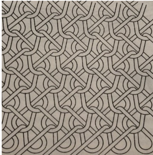
Obr.1: Způsob pletení nevstřebatelné střední vrstvy prototypu cévní protézy
