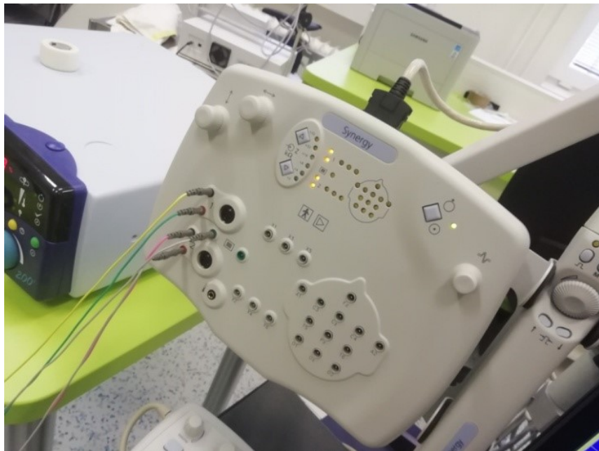
Obr. 13: Zapojení snímacích elektrod při vyšetření MEP (autorské foto)
