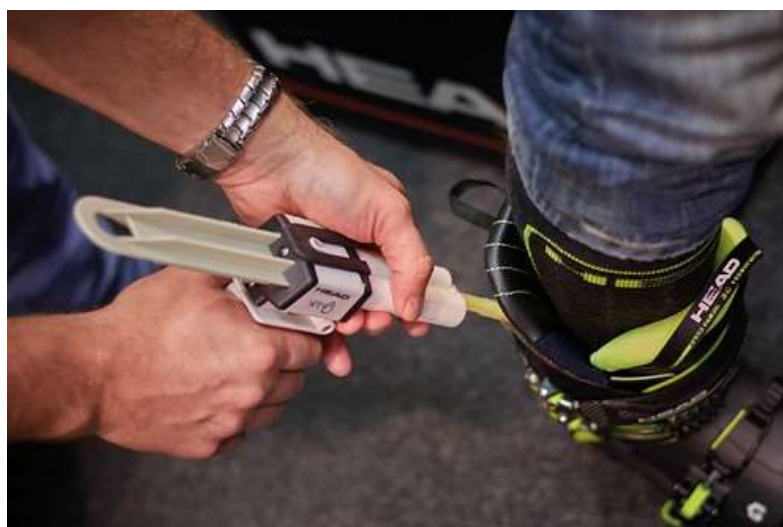
Obrázek 31 Ukázka plnění kapes tekutou hmotou pomocí hadičky (snow.cz)
