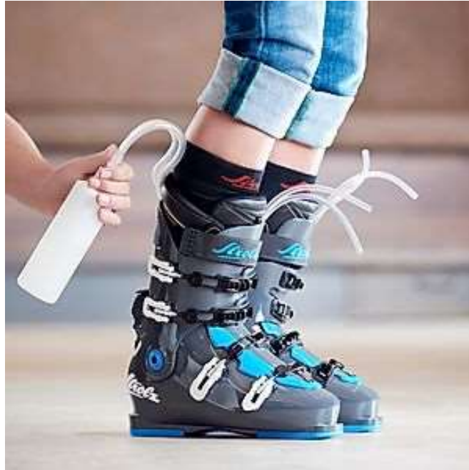
Obrázek 33 Ukázka vyplňování bot pomocí dvousložkové pěny (en.strolz.at)
