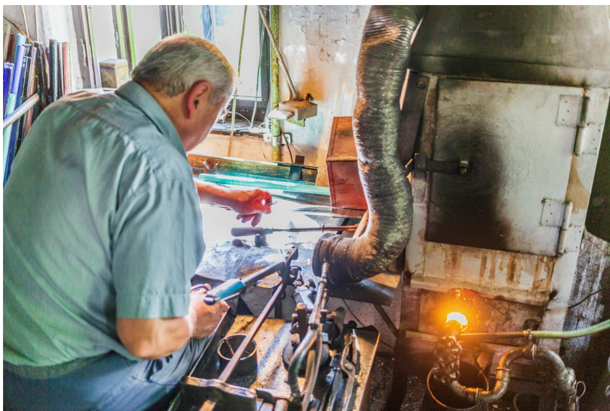
Mačkání knoflíků, mačkář Klement Rýdl ve Smržovce v mačkárně Jaroslava Lipského. Foto Filip Švácha.
