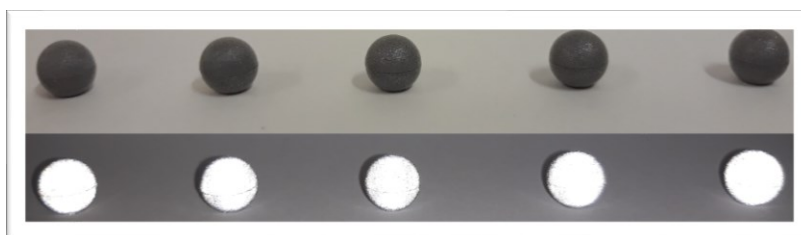
Obrázek 35 – Pasivní markery vel 12,5 mm (+ jejich znázornění při odrazu světla)
