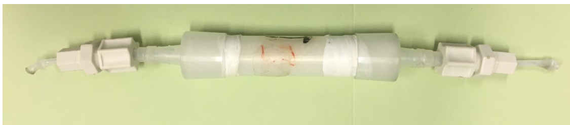
Obr. 4.6 Použitá sušící patrona naplněná hydroxidem sodným.
