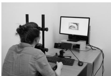
Obrázek č. 7 – Eye trackingové zařízení Eyelink 1000plus s nutností fixace hlavy v Národním ústavu duševního zdraví v Klecanech
