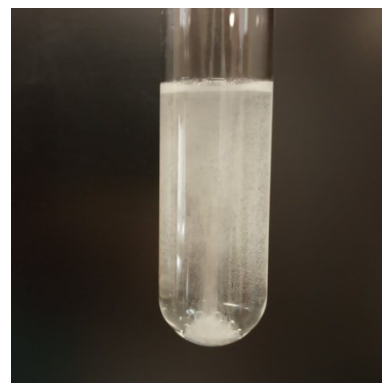
Obr. 19 - Průběh reakce, vznik bublinek \text{H}_2
