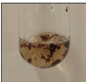
Obr. 24 - Vznik \text{MnO}_2 při vyšší koncentraci \text{KMnO}_4 , koagulovaná sraženina
