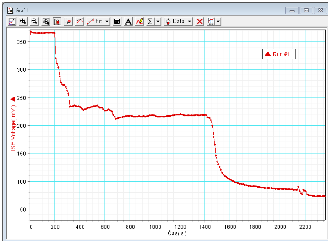
Obr. 16 – Graf dlouhodobého měření redoxního potenciálu při reakci \text{Fe} + \text{CuSO}_4 \rightarrow \text{Cu} + \text{FeSO}_4
