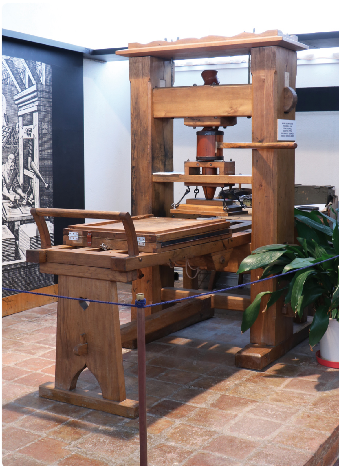
Obr. 26: Návrh rekonstrukce knihtiskařského lisu
