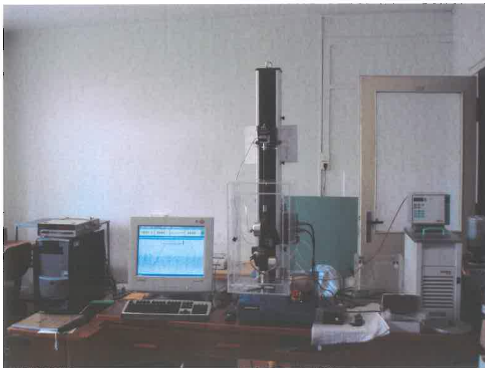
obr. (71): Měřicí systém Instron 3343 s řízenou teplotní komorou a teplotním regulačním systémem Julabo F25.
