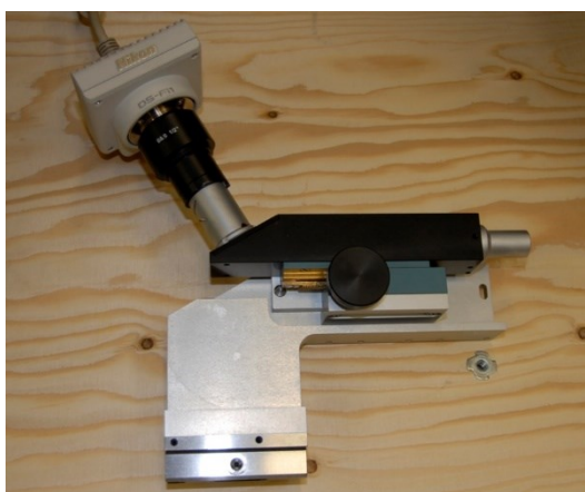
Obr. 4 digitální mikroskopická kamera NIKON DS F1 s optickým adapterem na tzv. justačním mikroskopu
