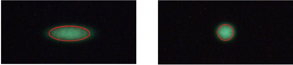
Obr. 8 výřezy pracovního okna systému obrazové analýzy, překryvné obrazy (červené elipsy) vyznačující velikost a pozici stopy primárního svazku při úhlu 20^\circ (vlevo) a 70^\circ (vpravo), pod červenými konturami překryvné masky je živý obraz, v tomto případě homogenní fluorescenční terčik
