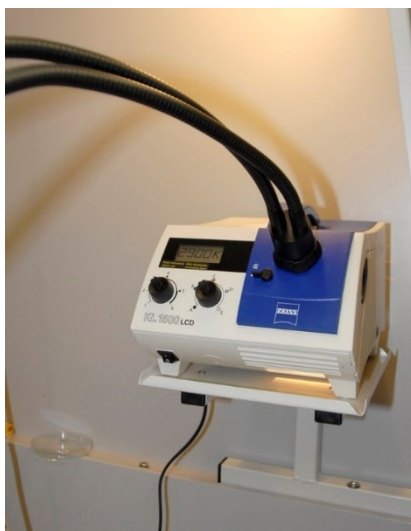
Obr. 6 umístění zdroje studeného světla v komoře difraktometru
