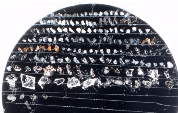
Obr. 40 jeden z prvních syntetických vzorků známých minerálních fází, který byl použit hledání optimálních parametrů pro nastavení celého systému
