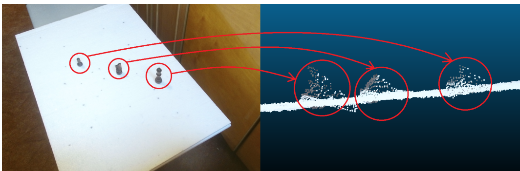
Obrázek 1.6: Vizualizace problému odlétávajících pixelů. Vlevo snímek scény z barevné kamery. Vpravo boční pohled na mračno bodů představující figurky.
