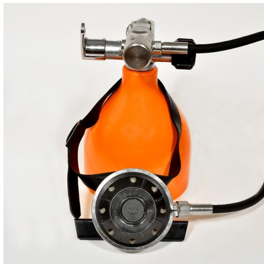
Obrázek 6 – Dýchací automatika Tajfun (VSC – sbírka techniky, 2012)
