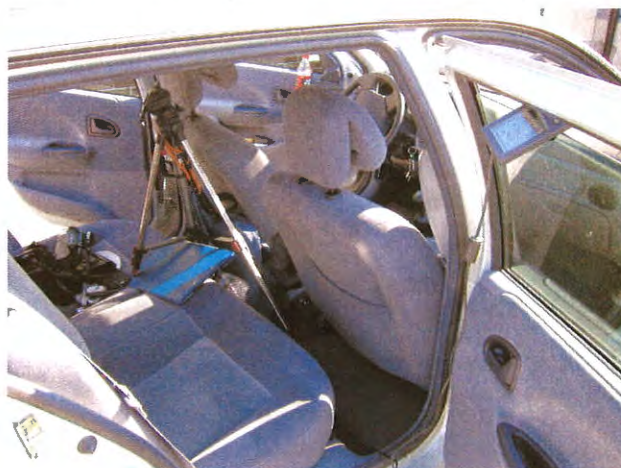
Obrázek 18 – GPS Navigátor – Příprava vozidla pro testování (všimněte si GPS přijímače sevřeného sklem okna do rámu dveří – externí anténu jsme neměli)
