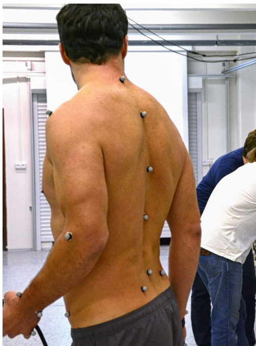
Obr. 14: Umístění pasivních markerů pro systém Qualisys ( www.marrko.com ).
