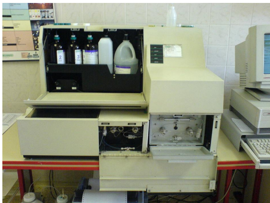
Obr. č.2: Analytický systém REMEDi HS – uložení reagentů a kolon
