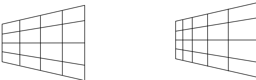
Obrázek 8-2: Rozdíl v mapování textury bez použití korekce perspektivy (vlevo) a s použitím korekce perspektivy (vpravo)
