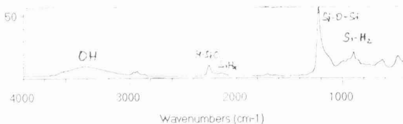
Obr.V.4 : Infračervené absorpční spektrum vzorku S20 s vyznačením odpovídajících absorpčních skupin. Upozorňujeme na možnost porovnání s obr.II.10.
