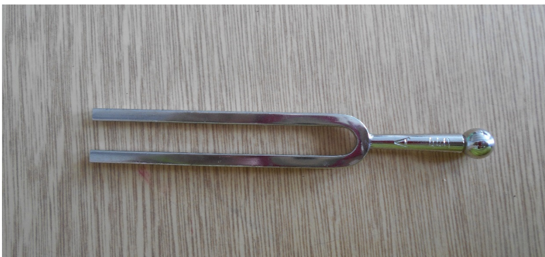
Obr. 10: Mechanická (rezonanční) ladička
