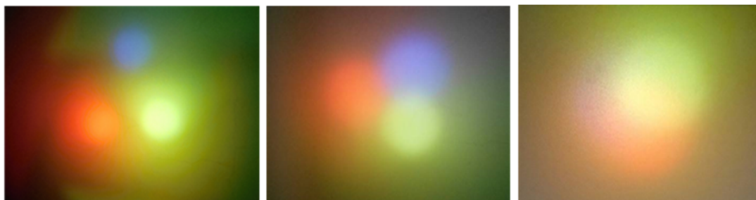
Obr. 16: Míchání barev při přibližování jednotlivých barevných kuželů ze světelných zdrojů do jedné stopy
