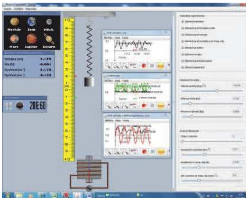
Obrázek 1.10: Pokus o integraci reálných a simulovaných hodnot do jednoho prostředí pro snadné modelování a srovnání v české vzdálené laboratoři (reálná experimentální data lze snadno importovat ze vzdáleného experimentu). Autorem simulačního prostředí „ISES Sim Lab“ byl v r. 2011 student V. Bardiovský. [122]
