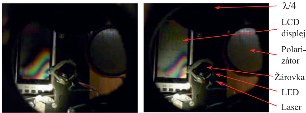
Obrázek 2.19: Pohled na vzdáleně řízenou aparaturu experimentu Polarizace světla z webkamery umístěné v optické ose. Hned před kamerou je otočný polarizátor (tzv. analyzátor). Při osvětlení LCD displeje údaje na něm zobrazené mizí (viz obr. vlevo) a znovu se objevují (viz obr. napravo), jak se analyzátor otáčí, a duhovým zbarvením se projevuje mechanické napětí v průhledném krytu displeje. Pro orientaci jsou označeny různé zdroje světla, které lze v úloze zkoumat z hlediska polarizace, a další optické prvky, které lze zařadit do optické dráhy nebo je vyjmout (např. druhý polarizátor a čtvrtvlnná fázová destička „ \lambda/4 “). 138
