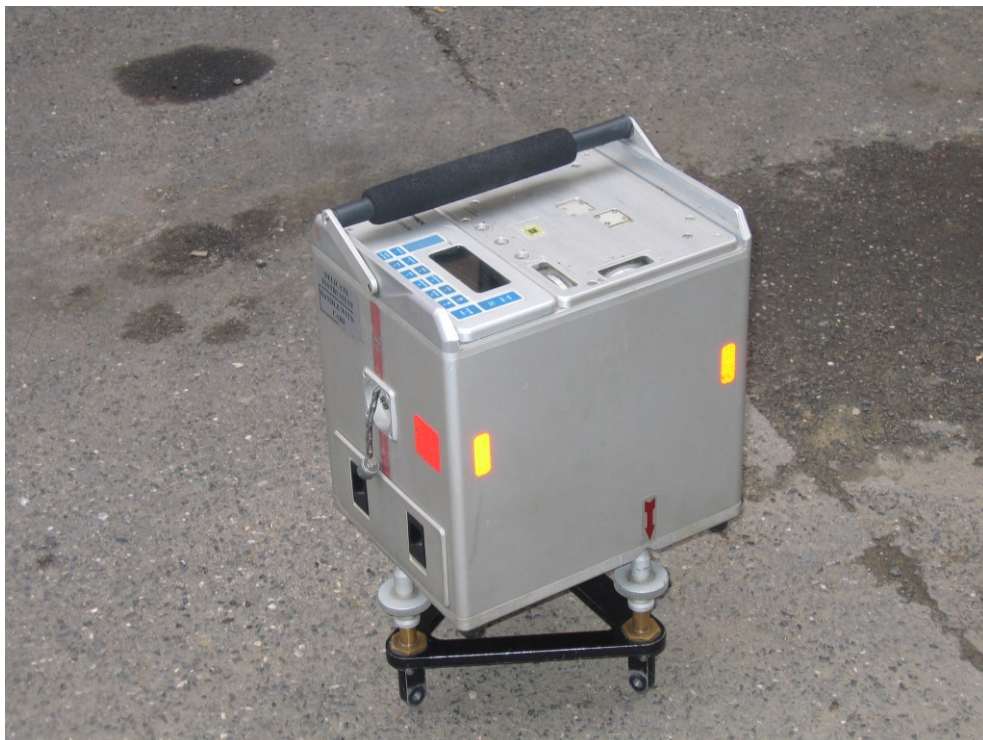
Obrázek 10 Gravimetr CG3M, který byl použit na lokalitě Rybí loučky v Jizerských horách
