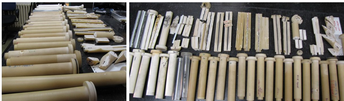
Obr. 3-2 Kapiláry poškozené v počátečním stadiu vývoje aparatury CAPEX.
