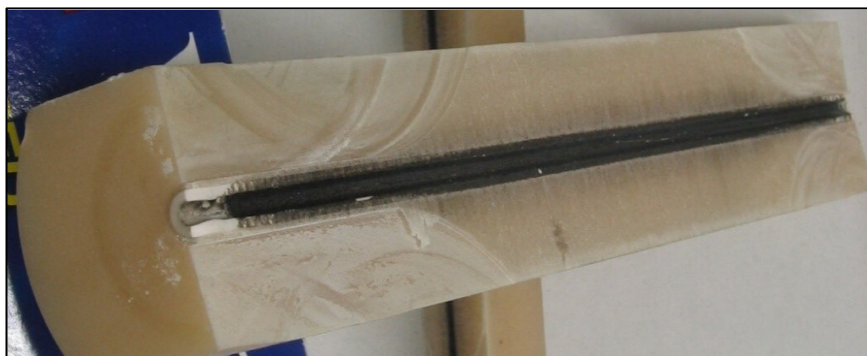
Obr. 3-4 Typicky prasklá keramická kapilára o délce 320 mm a o vnitřním průměru 3 mm s polyuretanovým pláštěm. Stav po rozříznutí polyuretanového pláště poblíž okrajů a po rozlomení konců keramické kapiláry - bílý lom v délce cca 10 mm.
