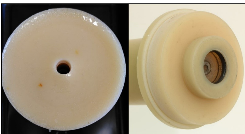
Obr. 3-10 Detail vysokonapětového konce odlité kapiláry po odlití (vlevo) a po obrobení a osazení vnitřním o-kroužkem pro radiální těsnění (vpravo).
