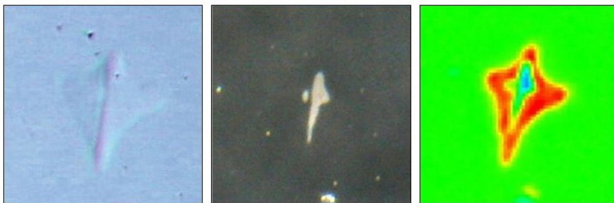
Obr. 5-2 Ukázka stop zeslabeného XUV laseru CAPEX s jednotnými parametry na PMMA ( vlevo ), na třívrstevném vzorku Pt(3nm)Co(5nm)Pt(3nm) na safírovém substrátu s orientací 001 ( uprostřed ). Oba snímky jsou pořízeny metodou popsanou v části Metoda "šikmého pozorování" neviditelných stop běžným mikroskopem (4.4.) (Zkreslení bylo kompenzováno). Vpravo je ve stejném měřítku výsledek magnetického měření Ker rotace. (Velikost hrany zobrazených čtverců je 200 \mu\text{m} .)
