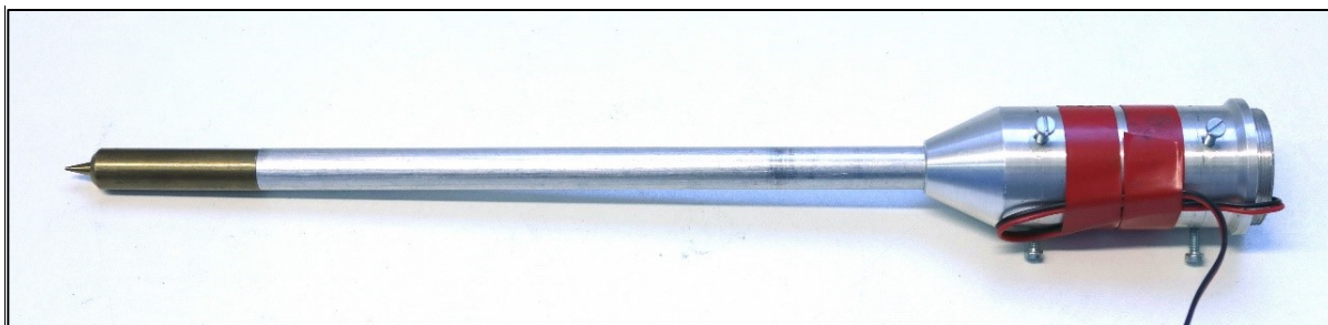
Obr. 4-1 Viditelný laserový zaměřovač pro nastavování optických prvků aparatury CAPEX. Jeho paprsek vychází směrem doprava a je nastaven do osy hrotu na levé straně.
