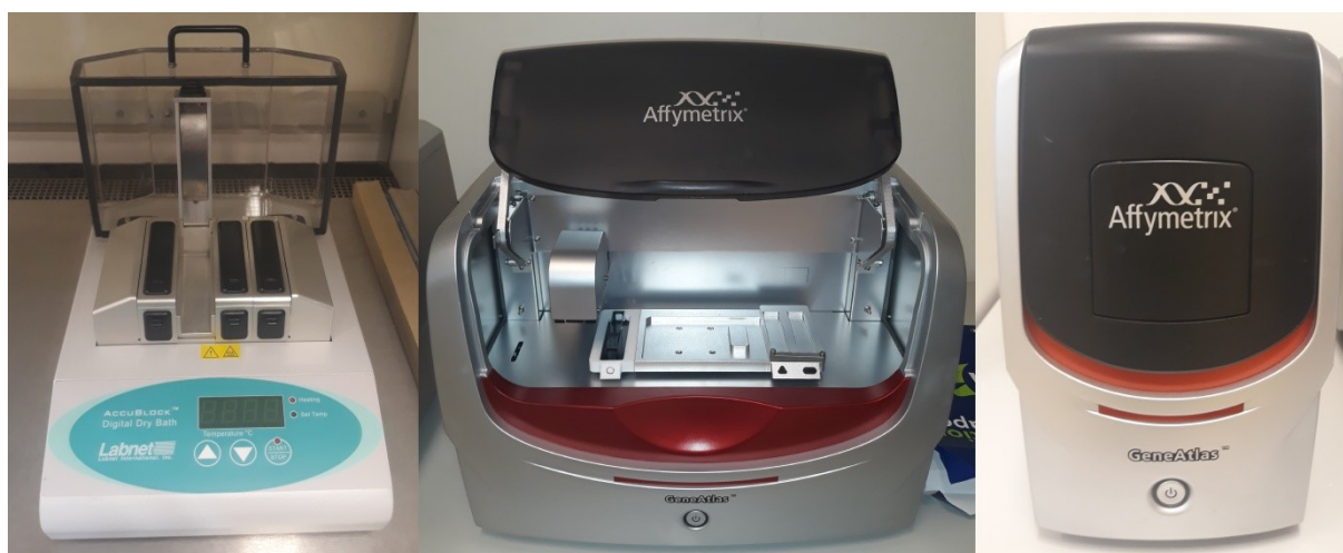
Obr. 3. Hybridizační stanice (vlevo), promývací stanice (uprostřed) a zobrazovací zařízení Affymetrix (vpravo)
