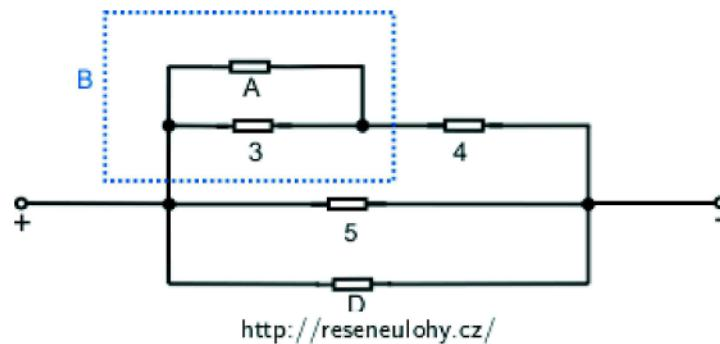
Rezistor B vzniknul nahrazením paraleleně zapojených rezistorů A a 3. Napětí na těchto rezistorech je tedy stejné a je stejné jako napětí na rezistoru B.
