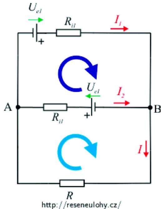
Z předchozích výpočtů víme, že máme-li dva paralelně zapojené zdroje o elektromotorickém napětí  $U_{e1}$  a  $U_{e2}$  s vnitřními odpory  $R_{i1}$  a  $R_{i2}$ , pak pro celkové elektromotrické napětí a celkový odpor platí
