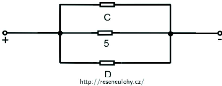
Nyní se vraťme k obvodu s rezistory C, D a 5, napětí na těchto rezistorech je stejné (viz návod) a je stejné jako napětí  $U$  na celém zapojení
