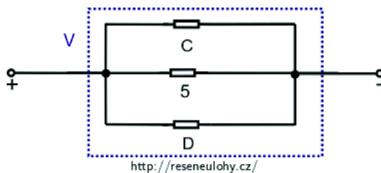
Rezistory C, D a 5 jsou zapojeny paralelně
