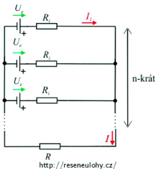
Metodou lineární superpozice vyjádříme proud  $I$  procházející rezistorem o odporu  $R$ . Výsledky vztah poté srovnáme s Ohmovým zákonem pro uzavřený obvod a odsud určíme hledané elektromotorické napětí a vnitřní odpor náhradního zdroje.
