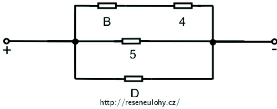
Rezistor C vzniknul nahrazením sériově zapojených rezistorů B a 4. Těmito rezistory musí procházet stejný proud jako nahrazujícím rezistorem C
