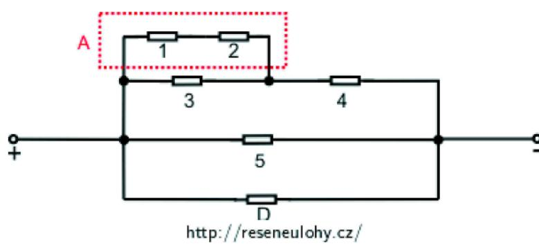
Rezistor A vzniknul nahrazením sériově zapojených rezistorů 1 a 2, tedy proud procházející těmito rezistory je stejný jako proud procházející rezistorem A.
