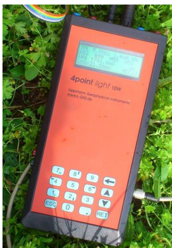
Obr. 22 (nahore) přístroj 4point light 10w použitý k ERT měření.
