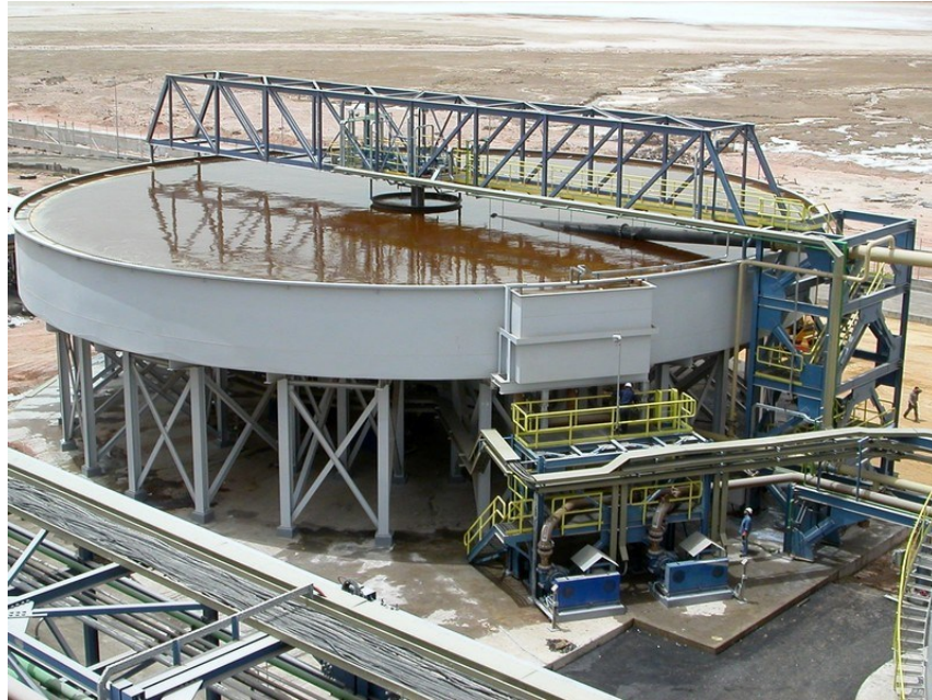
Obrázek 21: Vysokokapacitní kruhová zahušťovací nádrž. Zdroj: Enviro-Clear.
