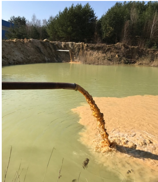
Obrázek 40: Primární kal přitékající z Dorrovy nádrže do první usazovací nádrže.
