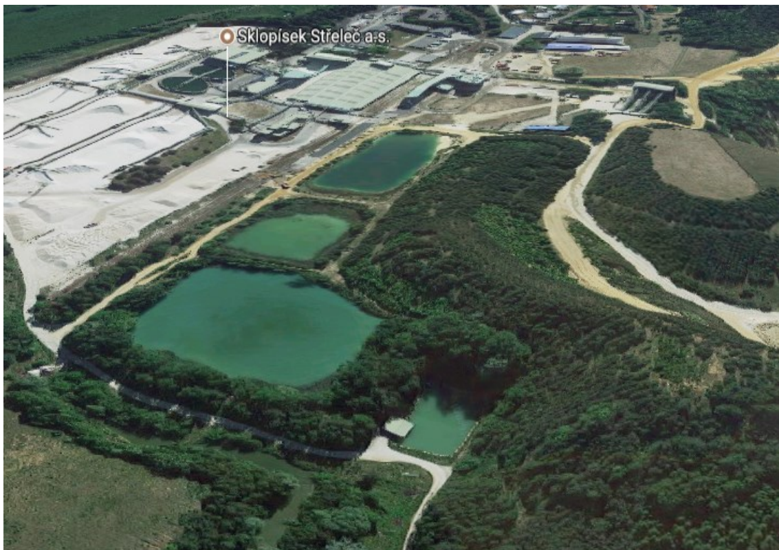
Obrázek 7: Soustava zbylých usazovacích nádrží po vybudování ochranného valu a kalolisovny. Aktuální stav. Zdroj: 3D mapy Google.
