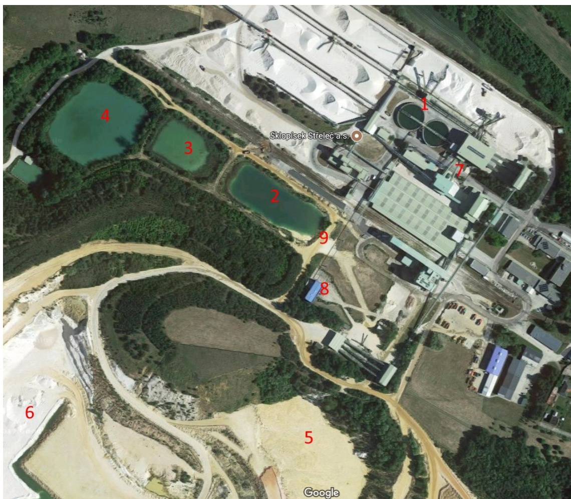
Obrázek 36: Přehled. 1- Dorrovy usazovací nádrže, 2- první usazovací nádrž, 3- druhá usazovací nádrž, 4- akumulční nádrž, 5- trvalé odkaliště/výsypka, 6- dobývací prostor, 7- mokrá úpravna, 8- prostor kalolisovny, 9- místo kde dochází k prokopání hráze při vybírání kalů.
