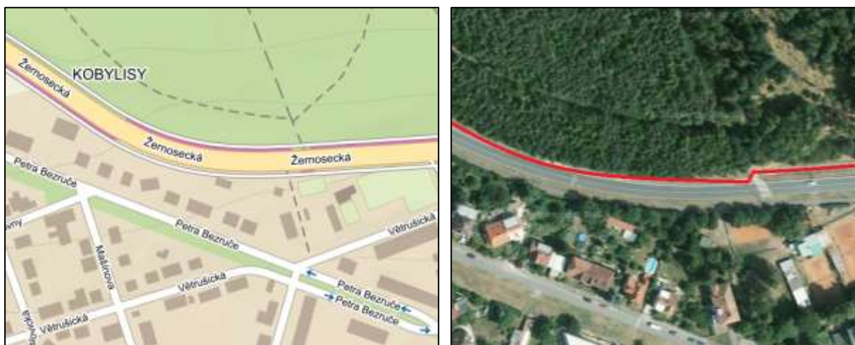
Obr 11 a 12: Srovnání skutečné situace (vpravo) a databáze (vlevo). Cyklotrasa je v místě v obou směrech vedena po izolovaném tělese na jedné straně komunikace, databáze vede cyklotrasu přerušovaně po komunikaci a to po obou stranách Žernosecká ulice, Praha 8 – Kobyliše. Zdroj: Mapy.cz (2016), cyklotrasa na obr. 12 zvýrazněna autorem
