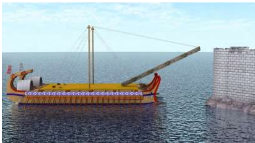
d: Antický obláhač stroj sambyké či sambuca používaná při námořním obléhání.
