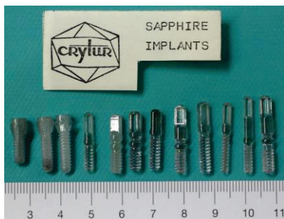
Obr. 4. Jednodílné implantáty z aluminiumoxidové keramiky, tzv. safírové implantáty (fotografie ze sbírky implantátů autora)
