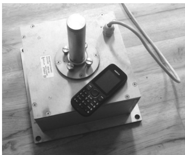
Obr. 15. Velikost elektrodynamického vibrátoru v porovnání s velikostí mobilního telefonu.
