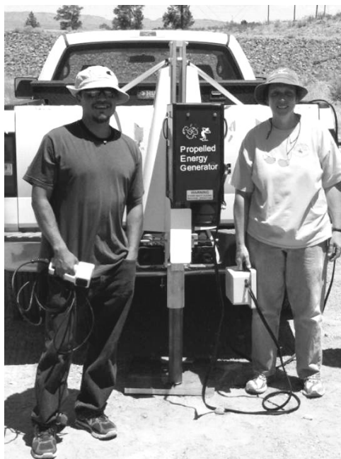
Obr. 10. PEG-40 instalovaný k automobilu a připravený na práci (převzato z https://www.passcal.nmt.edu ).
