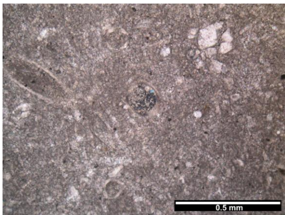
Obr. 16. Shluk kalcitových zrn (vpravo nahoře) v jemnozrnném mikritu, pozorováno ve zkřížených nikolech (vzorek HPV/I/3).
