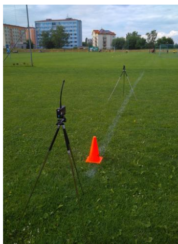
Obr. 11 – rozložení fotobuněk na startu
