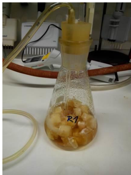
Obr. 6. – Snímek z digitálního fotoaparátu; kultivace P. ostreatus ve „fixed-bed“ bioreaktoru.
