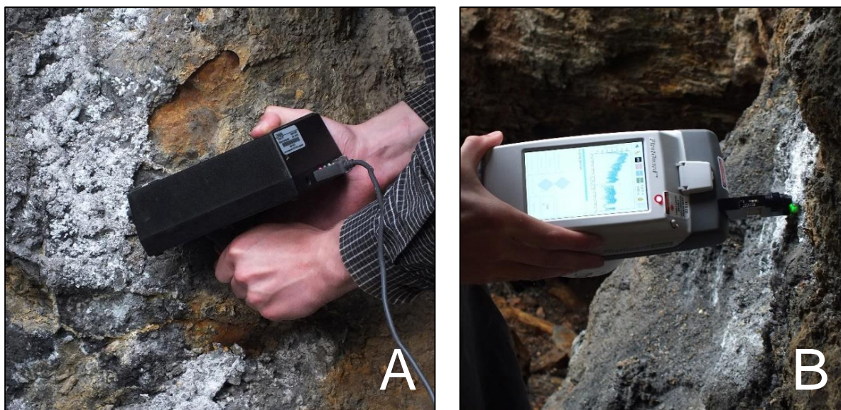
Obrázek 5: Přenosné Ramanovy spektrometry. (A) DeltaNu Inspector Raman 785nm. (B) Rigaku First Guard 532nm.
