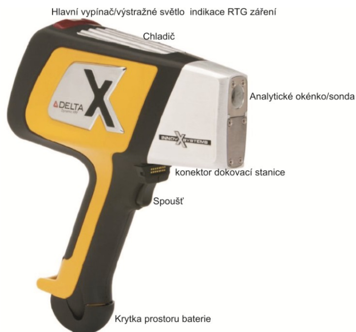
Obr. 4. Popis přenosného energiově disperzního spektrometru DELTA X (dle Bass Rudice 2011)
