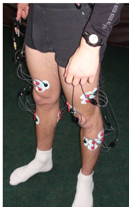
Obrázek 22: Lokalizace elektrod na přední straně DK
