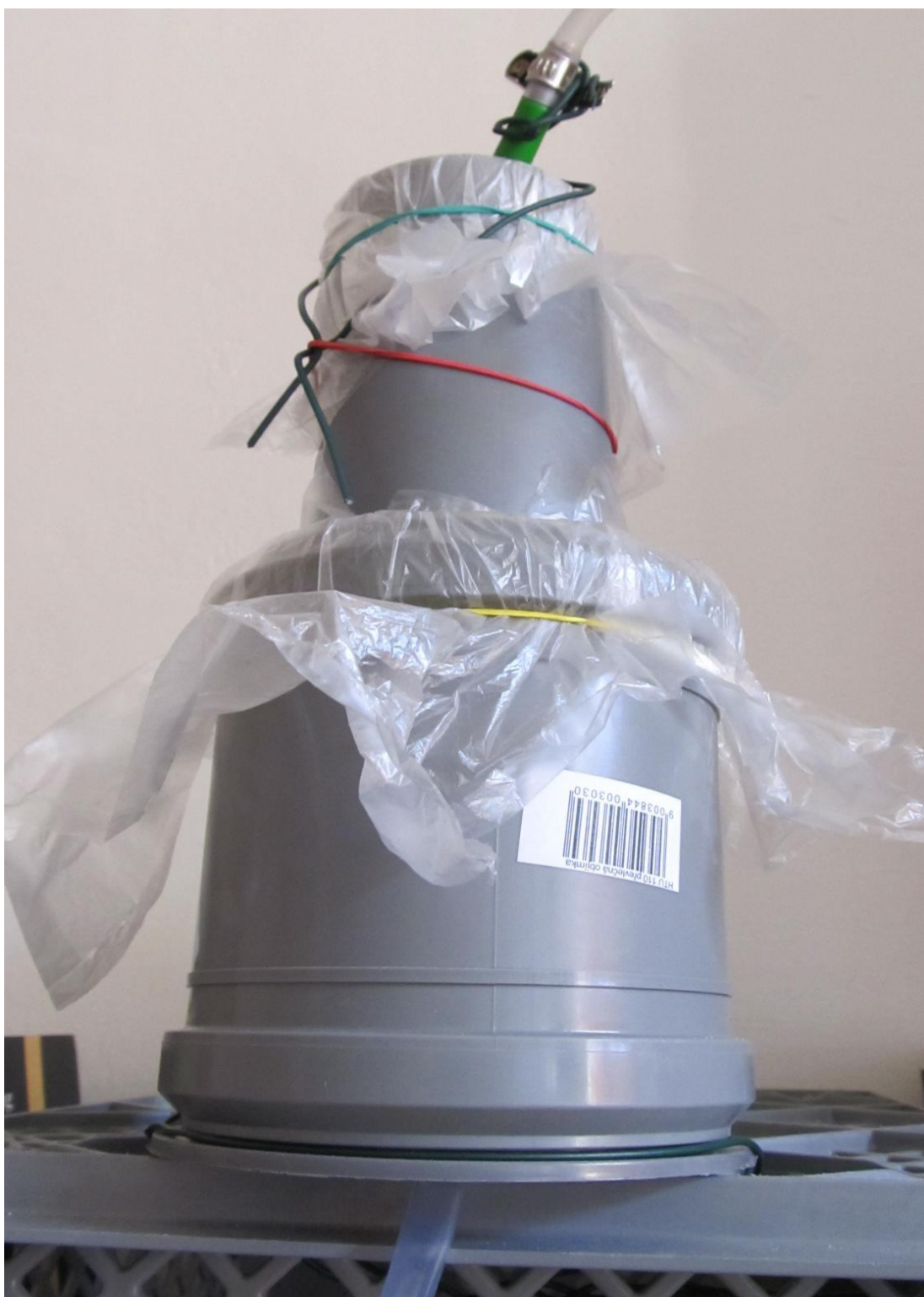
Obr. 10: Část aparatury GII - nádoba s pískem a se sádrovcem
