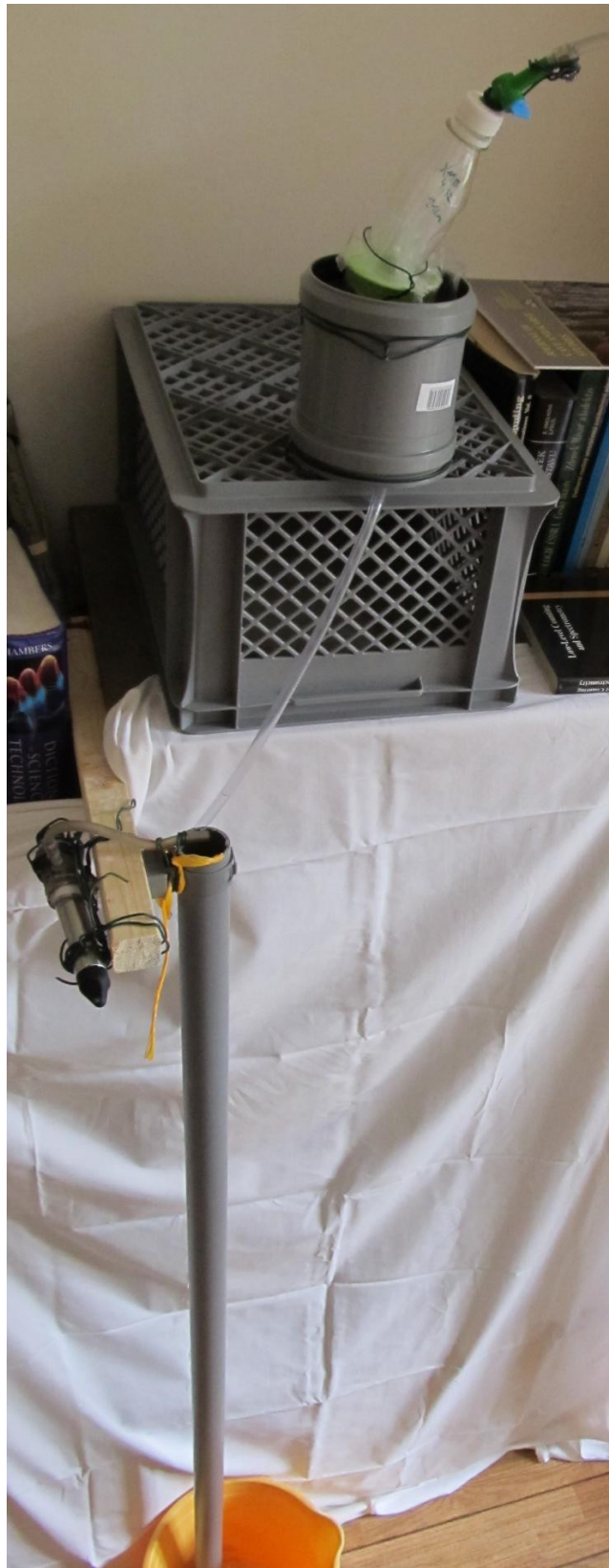
Obr. 8: Aparatura GI mimo barel s destilovanou vodou
