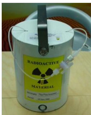
obrázek 5: Generátor ^{68}\text{Ge} / ^{68}\text{Ga}
