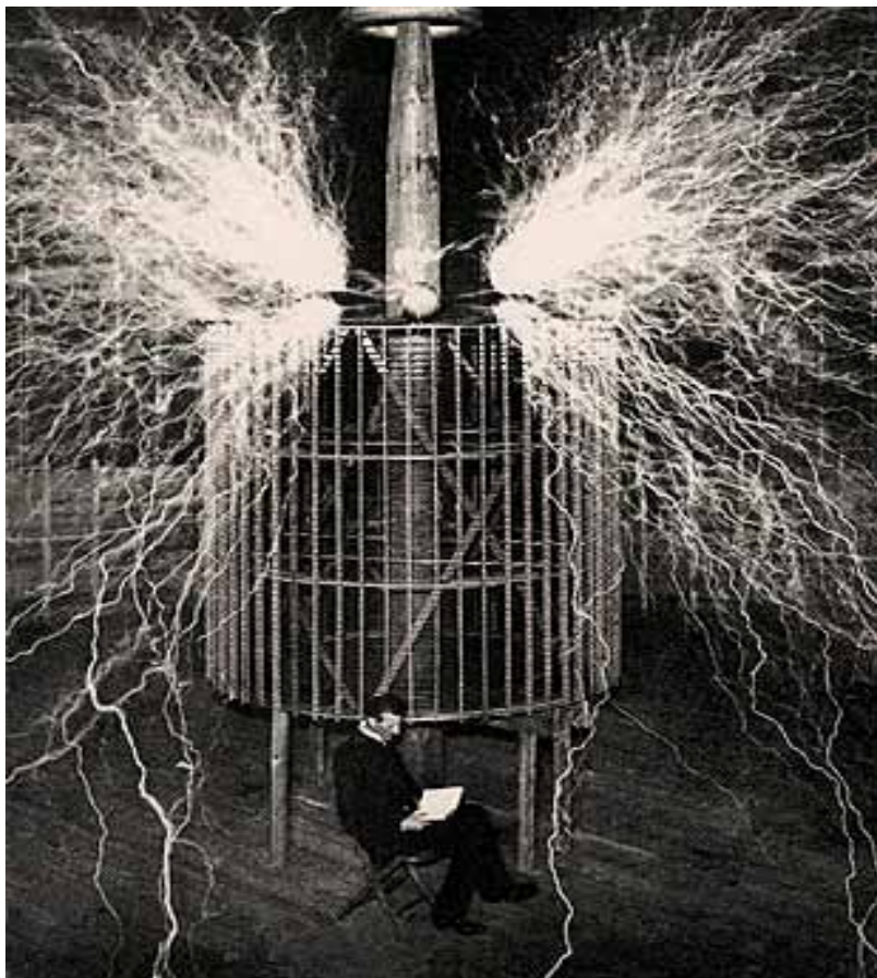
Pokusná zkouška elektrických procesů v oscilátoru v Teslově laboratoři v Colorado Springs
