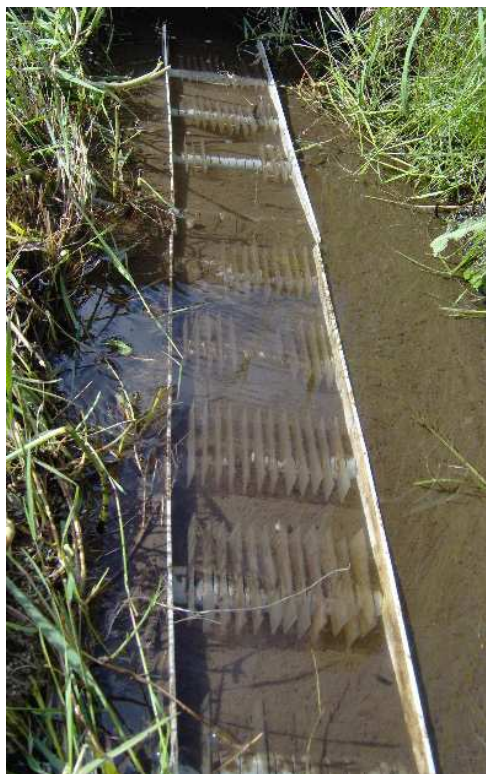
Obr. 6. Umístění sklíček s přírodním a umělým biofilmem na dně potoka.
