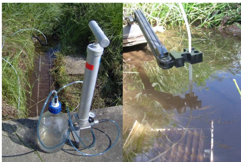
Obr. 8. Odběr vzorků vody pomocí ruční pumpy a teflonové hadice do odběrové nádoby.
