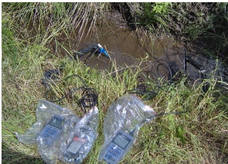
Obr. 9. Elektrody pro měření pH, DO a vodivosti umístěné do potoka.
