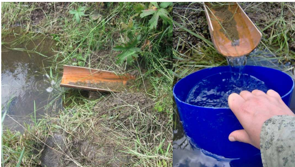
Obr. 10. Měření průtoku pomocí kalibrované nádoby.
