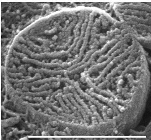
Obr. 2: Snímek ze skenovacího elektronového mikroskopu; izolované krysí subsarkolemální mitochondrie s lamelifornními kristami; (převzato z Hoppel et al, 2009)
