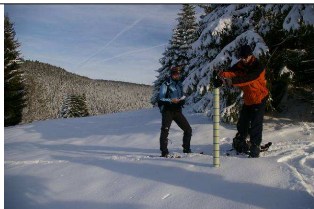
Foto 1: Měření sněhové pokrývky v Krušných horách
