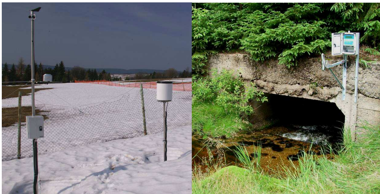
Obr. 5 Klimatologická stanice na Hřebečné v Krušných horách (vlevo), ultrazvukový hladinoměr v pramenné oblasti Otavy (vpravo). Foto M. Jeníček, J. Kocum
