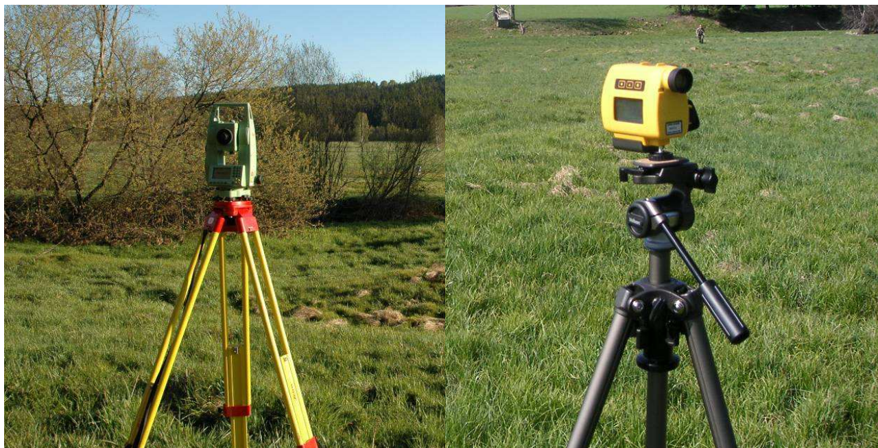
Obr. 6 Totální geodetická stanice (vlevo), laserový dálkoměr a sklonoměr LaserAce (vpravo). Foto J. Česák, M. Jeníček
