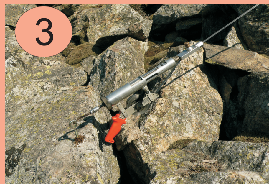
Obr. 3: Extenzometrické pásmo při měření na kamenném moři
