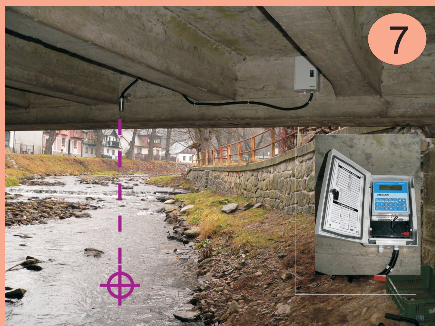
Obr. 7: Umístění ultrazvukového hladinoměru na mostě v Rejštejně. Fialová linka ukazuje směr paprsku od měřidla.
