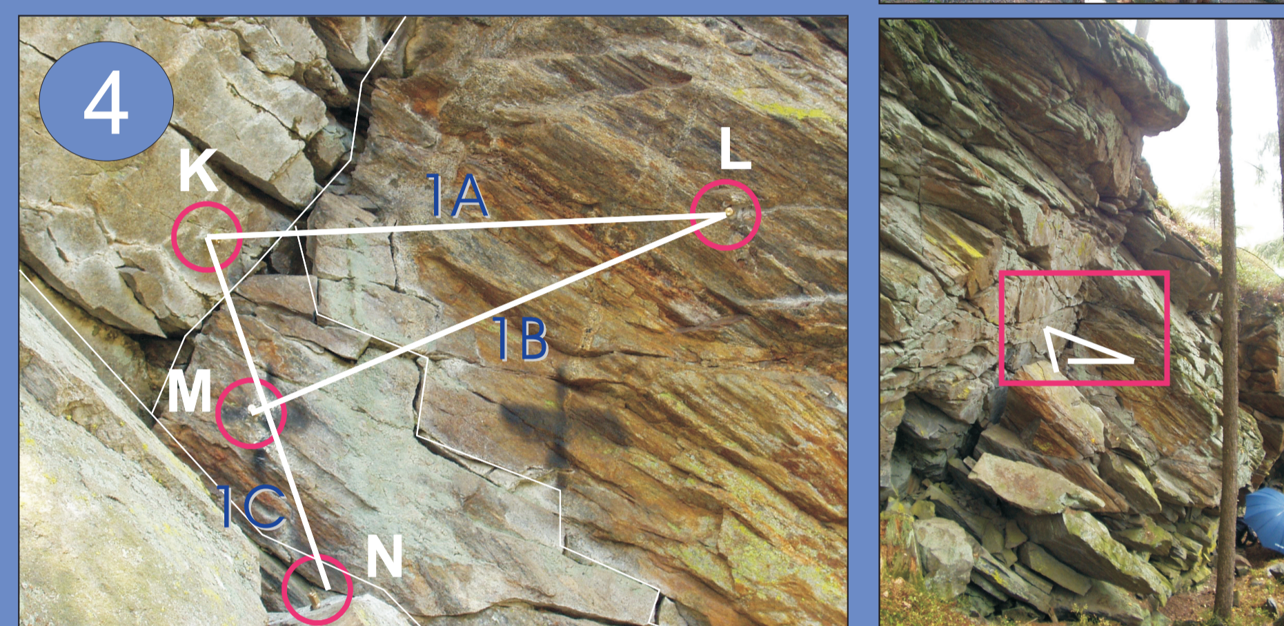
Obr. 4: Ukázka dokumentace dilatometrického monitoringu - skupina měření 1A-1B-1C
