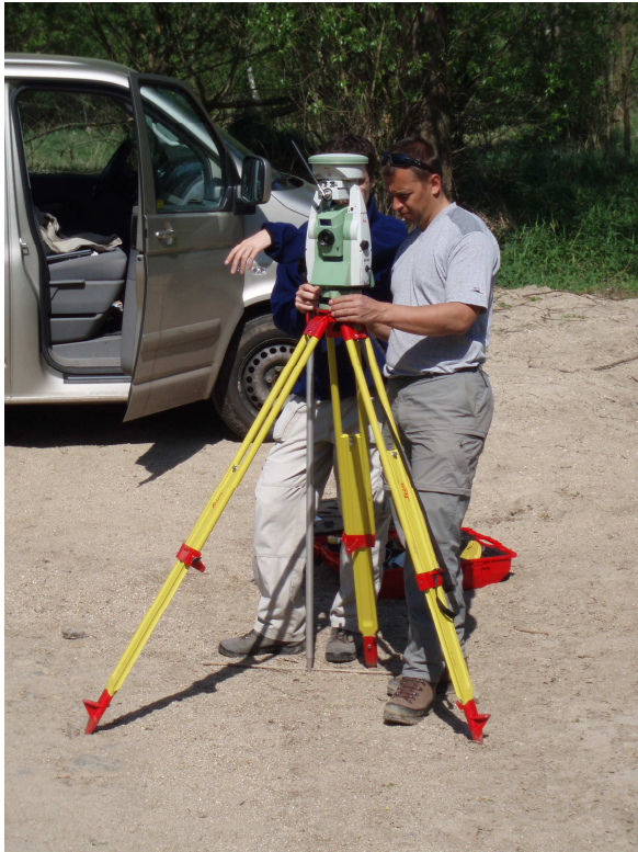
Obr. č. 11: Totální geodetická stanice Leica TCRP 1202+
